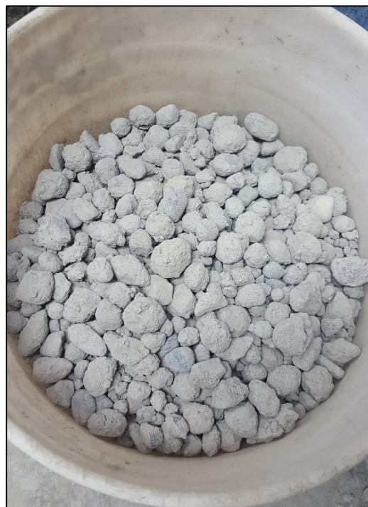
Fig.6: Producto final como agregado reciclado.
