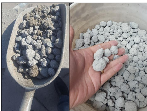
Fig.4: Pellets obtenidos en proceso de secado y a las 24 horas.
