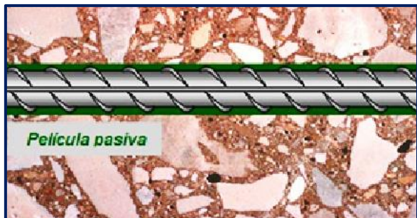
Fig.1: Película pasiva en la armadura de acero. Fuente: Naser et. al, 2017.
